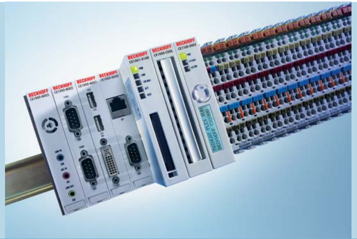
Embedded-PCs vom Typ CX1000 übernehmen im AMAG-Zentralersatzteillager die Gebäudesteuerung.
